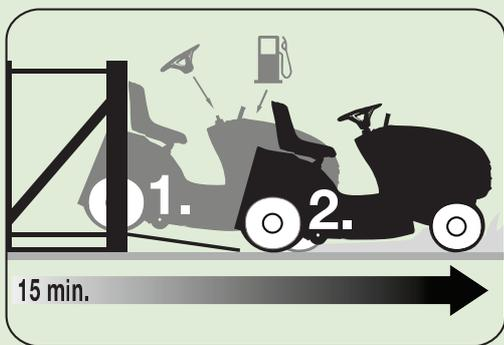
Alle OPTIMA Rasentraktoren sind mit betriebsbereiten und wartungsfreien Batterien ausgestattet. Alles was Sie tun müssen, nachdem Sie den Traktor ausgepackt haben, ist das Lenkrad anzuschrauben und den Sitz in Ihrer bevorzugten Position einzuschieben und mit dem mitgelieferten Werkzeug zu befestigen. Und dann einfach den vormontierten Fangkorb einhängen, die zwei Batteriekabel anschliessen und Benzin in den Kraftstofftank füllen – und fertig!
