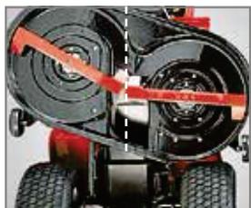
Gegenläufige Messer befördern bei Heckauswurf-Traktoren ab einer Schnittbreite von 92 cm und mit 2-Messer-System das Schnittgut auf kürzestem Weg in die Fangbox.
