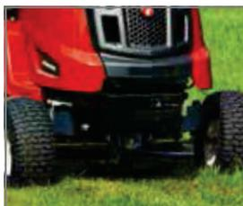
Pendelvorderachse zum Ausgleich von Bodenebenenheiten.
