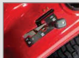
Handhebel bei Modellen mit Seitenauswurf
