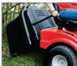
Leichtes Entleeren der Grasfangeinrichtung vom Sitz aus bei allen Heckauswerfern.
