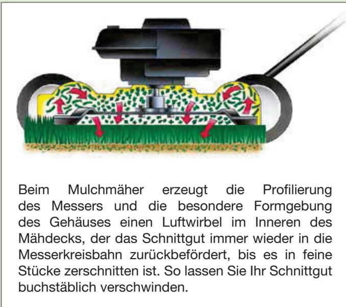
Beim Mulchmäher erzeugt die Profilierung des Messers und die besondere Formgebung des Gehäuses einen Luftwirbel im Inneren des Mähdecks, der das Schnittgut immer wieder in die Messerkreisbahn zurückbefördert, bis es in feine Stücke zerschnitten ist. So lassen Sie Ihr Schnittgut buchstäblich verschwinden.
