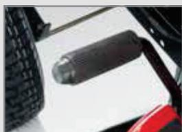
Kombiniertes Brems-/ Kupplungs-/ Gaspedal
