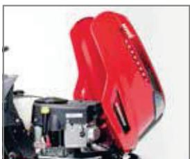
Motorhaube komplett nach vorn klappbar und werkzeuglos demonstrierbar, für bequemen Zugang bei Wartungsarbeiten am Motor.
